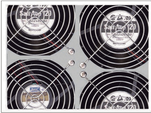
Velocidad de ventiladores controlado por nivel de carga
